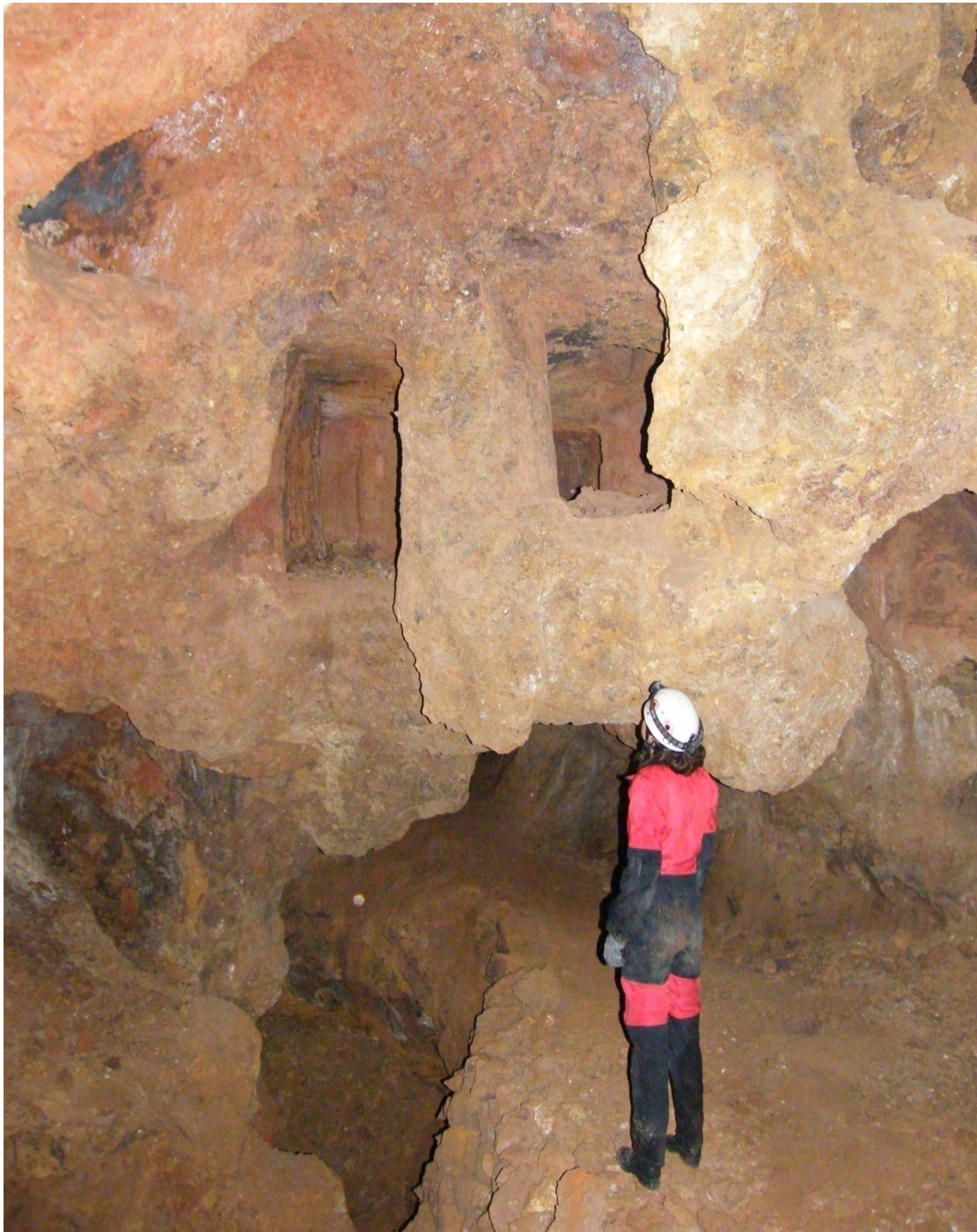
Εικόνα 3.7.5.2 Σύγχρονο μεταλλείο από την περιοχή του Λαυρίου. Στη διευρυμένη αίθουσα που διακρίνεται, είναι ορατές οι αρχαίες στοές ορθογώνιας διατομής.
