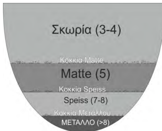
Εικόνα 3.9.2.1 Διαστρωμάτωση στο εσωτερικό της μεταλλουργικής καμίνου με τα ειδικά βάρη των επιμέρους στρωμάτων σε παρένθεση (Τροποποιημένο από Tylecote et al, 1997).
