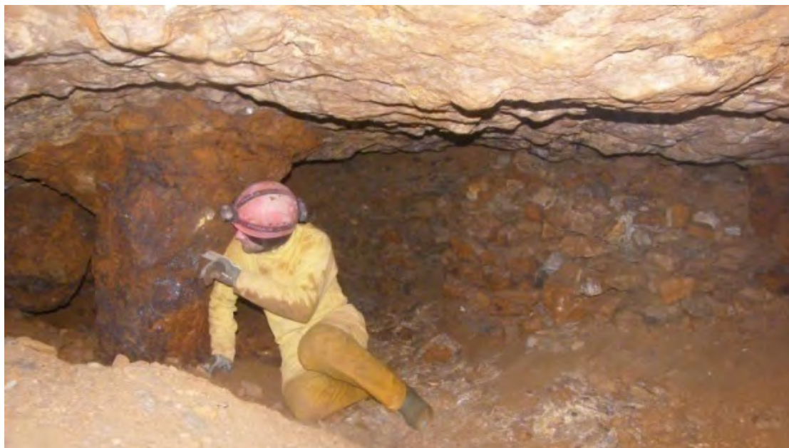
Εικόνα 3.7.5.4 Άποψη από το εσωτερικό μεταλλείου στην Παλαιά Καβάλα. Διακρίνεται ο στύλος ασφαλείας αποτελούμενος από ανεξόρυκτο σιδηρομαγνησιούχο μετάλλευμα.
