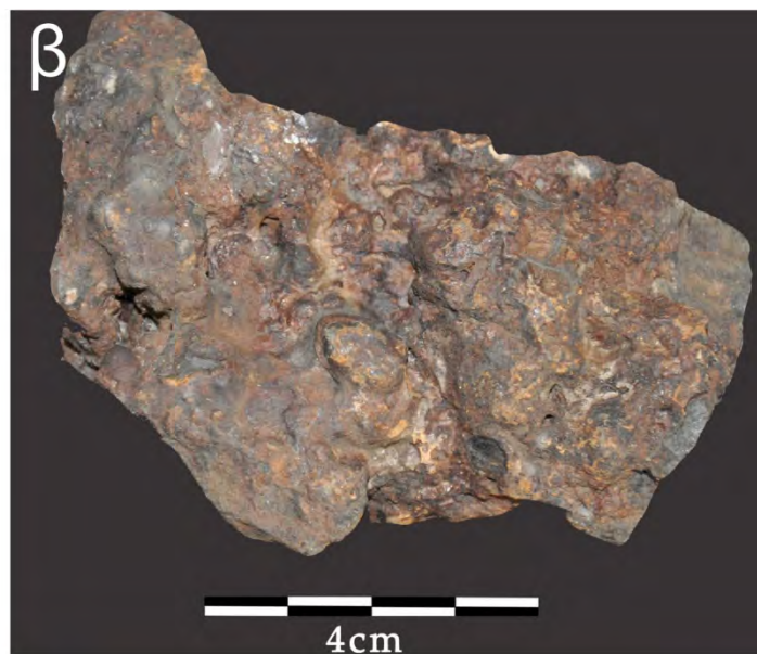
Εικόνα 9.5.2.1 Φωτογραφίες μεταλλουργικών σκωριών από τη Βαλτούδα. α) Μεταλλουργική σκωρία από τη θέση Α. β) Σκωρία spreiss από τη θέση Α στη Βαλτούδα. γ) Κρύσταλλοι μοντισελλίτη (Mo) σε υαλώδη μάζα (Gl). Πολωτικό μικροσκόπιο, N+. δ) Η εικόνα 9.5.6γ σε μεταλλογραφικό μικροσκόπιο, N//. Βουσιτίτης (Wus) μέσα σε πυριτική μάζα από μοντισελλίτη (Mo) και υαλώδη μάζα.
