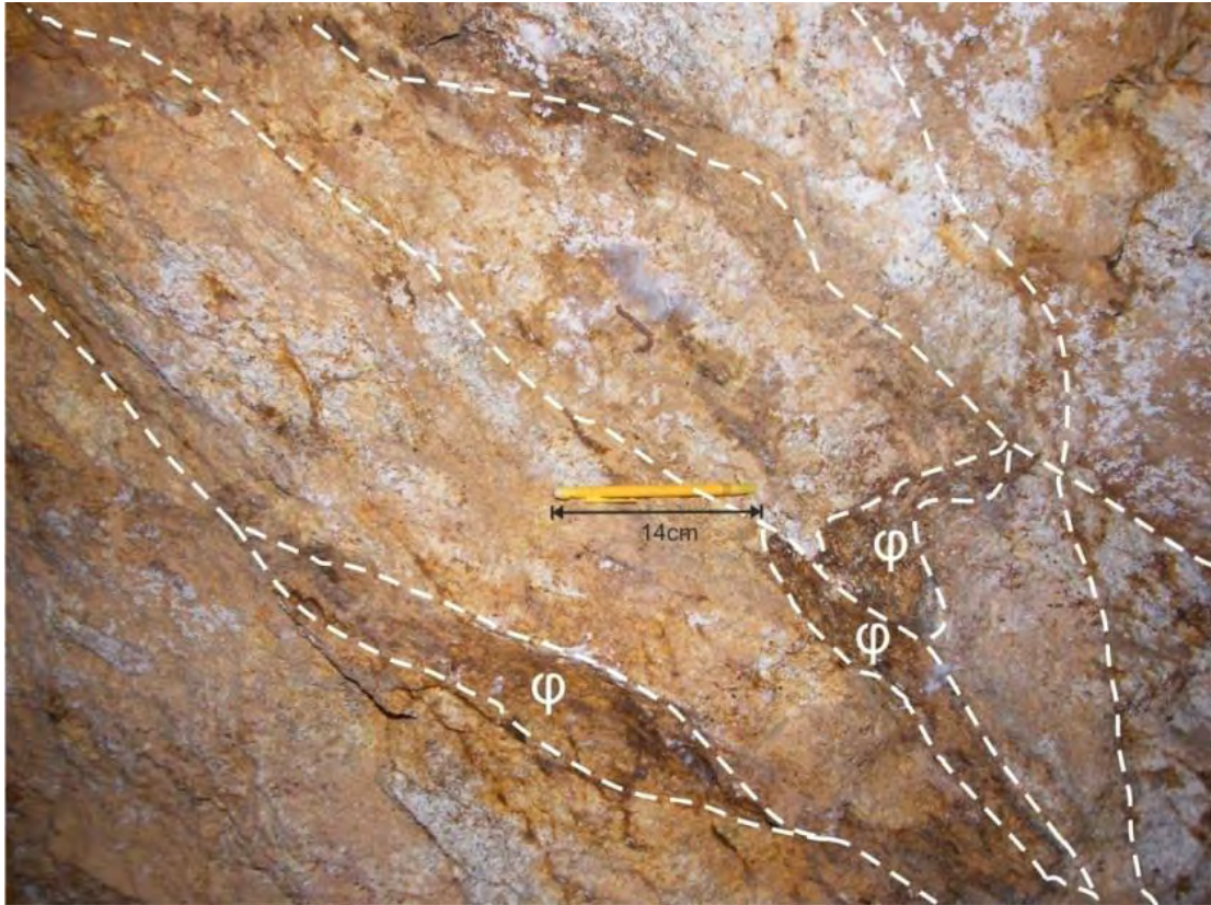
Εικόνα 7.3.2. Άποψη από το δυτικό πρανές του σύγχρονου μεταλλείου στην περιοχή της Νεροστριάς Νικήσιανης. Η μεταλλοφορία εντοπίζεται μέσα στη μάζα του γρανίτη σε φυλλώδεις φλέβες με παράλληλη-υποπαράλληλη διάταξη και σε φακούς (φ).
