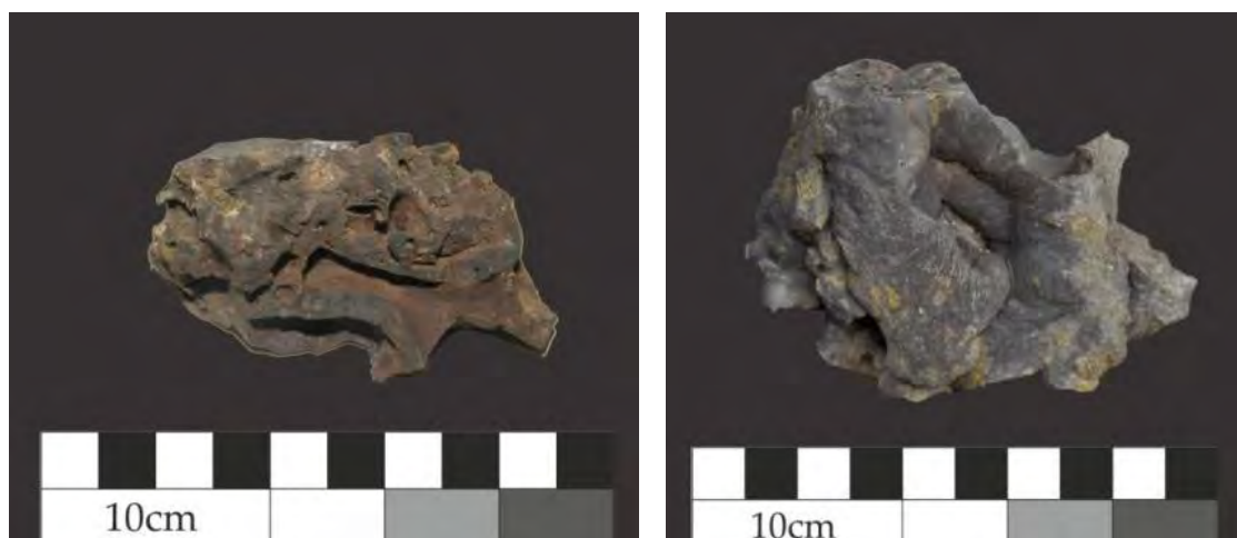
Εικόνα 9.3.2.1 α) Ημισυμπαγής σκωρία ρευστικής μορφής από το σωρό Α. β) Ημισυμπαγής σκωρία ρευστικής μορφής από το σωρό Β.
